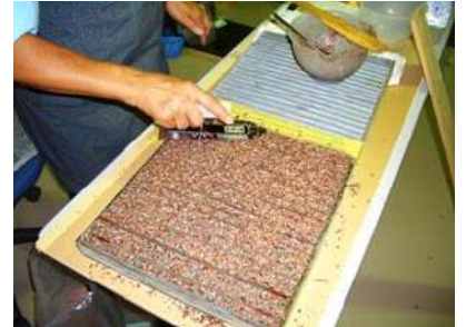
⑦リブの高さで仕上げる
